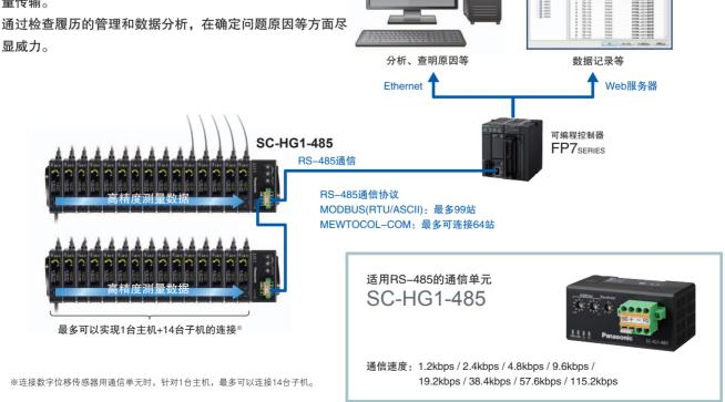
※连接数字位移传感器用通信单元时,针对1台主机,最多可以连接14台子机。
