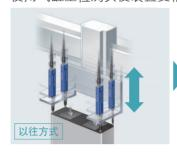
主轴根据空气的供应、切断 而上下动作
