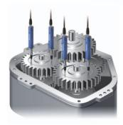
变速器零件的高度测量
